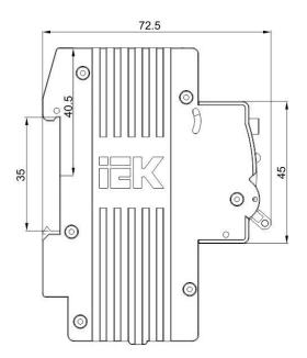
Рисунок 1 — Габаритные размеры АД12М
